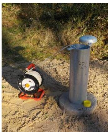
Les sondages piézométriques ont fait l'objet d'un relevé de niveau après stabilisation le 15 décembre 2019. Les piézomètres ont été dotés de têtes métalliques surélevées d'environ 50cm par rapport au terrain et munies de capots métalliques de protection verrouillables :
